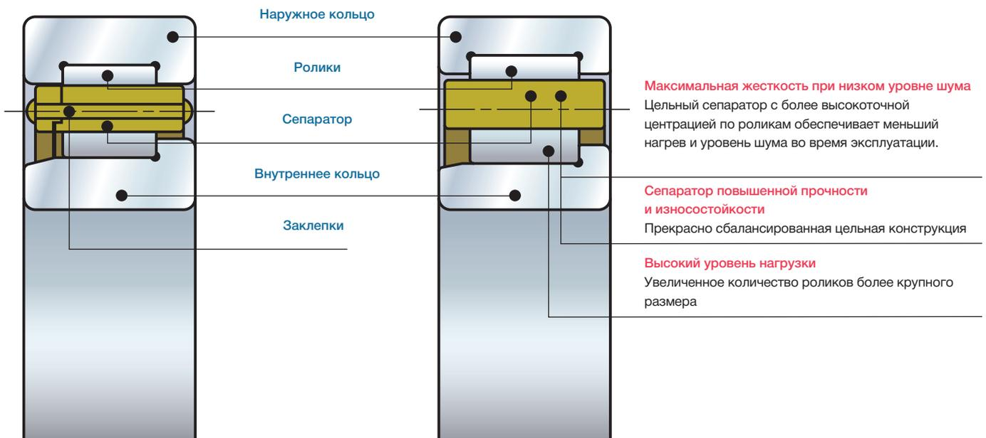
Компания NSK поставляет следующие стандартные сепараторы для однорядных цилиндрических роликовых подшипников, как указано ниже: Сепаратор традиционного исполнения: М-тип (с заклепками, состоит из двух частей, латунь, центрируемый по кольцу сепаратор).
