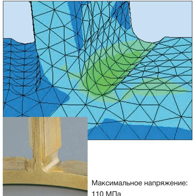
Испытания подтверждают, что уровень напряжения в сепараторах NSK серии EM на 50% ниже, чем в сепараторах серии М большинства конкурентов.
