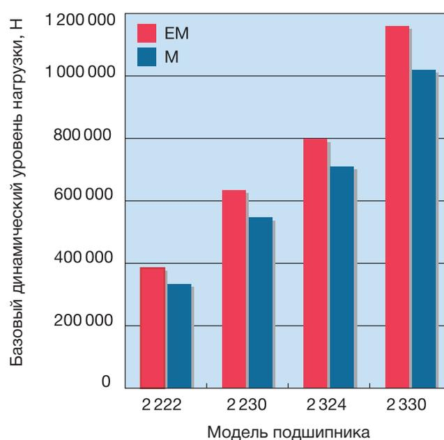
Сепараторы серии EM выдерживают уровень нагрузки на 30% больше, чем обычные сепараторы серии M.
